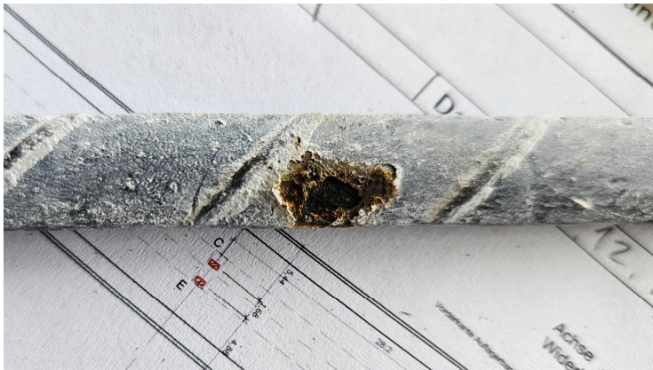
Lochfraß an Spanndraht
